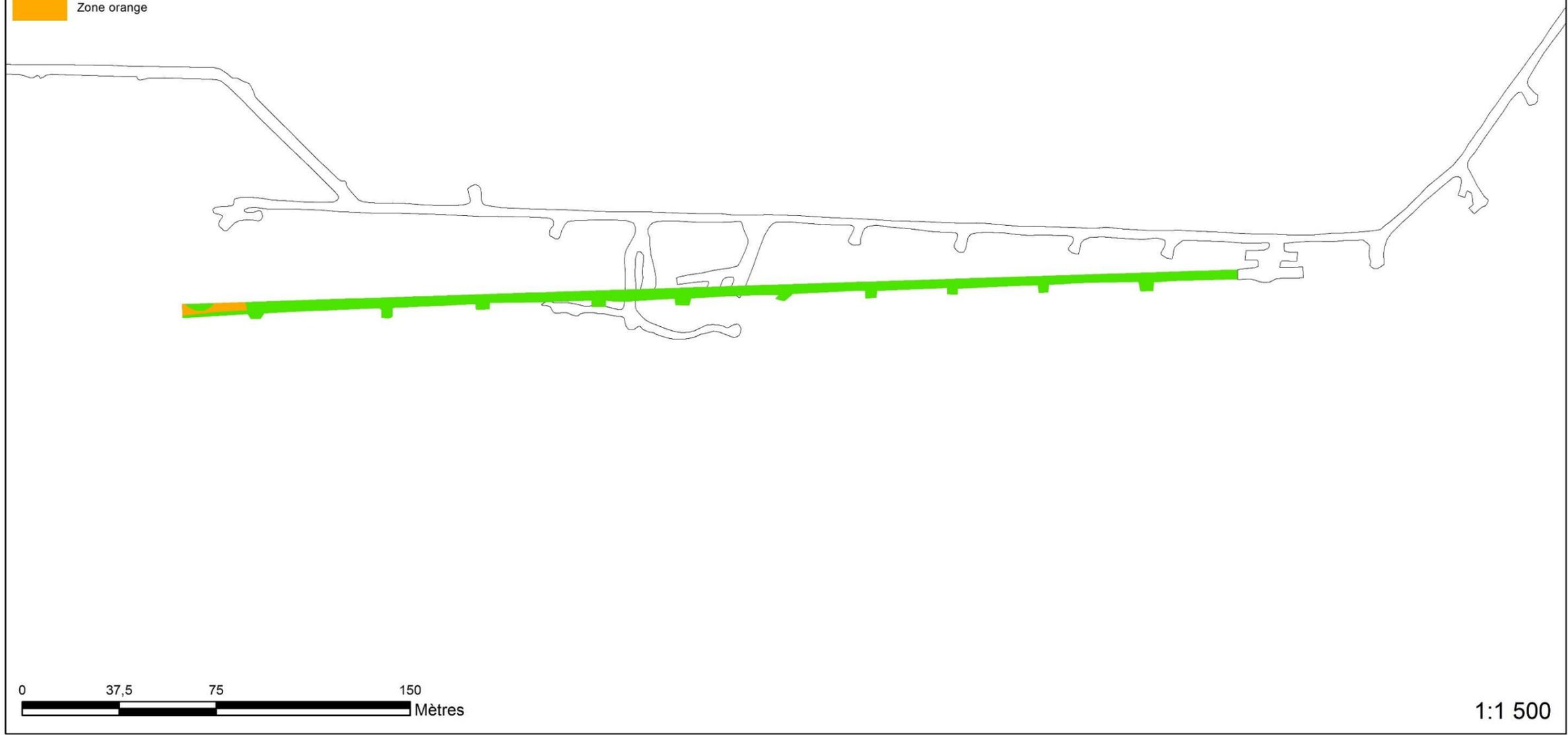
Figure 16 : Carte de la zonation du risque amiante du plan incliné entre les niveaux 1230 et 1320
